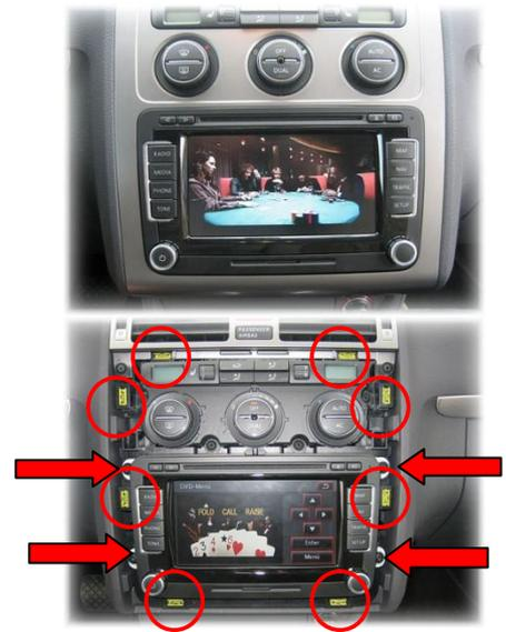
2. Quadlockstecker vom Navigationssystem lösen. Gemäß der Pinbelegung auf Seite 5, lose Audio / Video Anschlusskabel mit der 26pol AMP Buchse verbinden.
