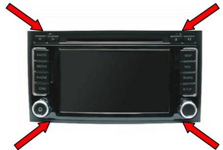
2. Quadlockstecker vom Navigationssystem lösen. Gemäß der Pinbelegung auf Seite 5, lose Audio / Video Anschlusskabel mit der 26pol AMP Buchse verbinden.
